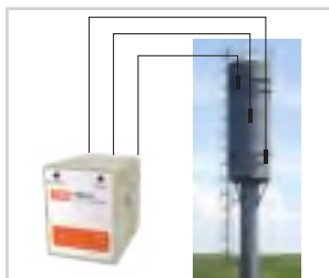
Автоматический контроль уровня воды в водонапорной башне.
