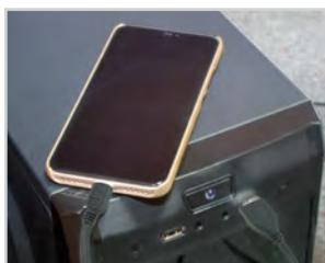
Для подключения мобильных устройств к источникам питания и синхронизации данных.
