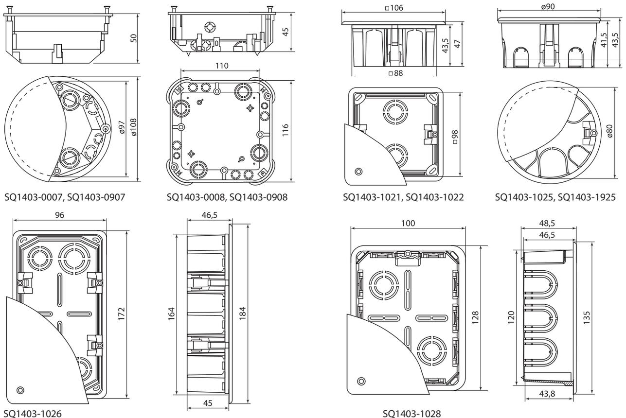
КОРОБКИ МОНТАЖНЫЕ УСТАНОВОЧНЫЕ СКРЫТОЙ УСТАНОВКИ ДЛЯ ПОЛЫХ СТЕН
