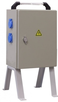
Щит механизации ЩМ-РУСП-32(УЗО)-2x16/3+1x16/5 IP54
