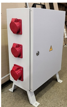
Щит механизации ЩМ-РУСП-80-3x16/3+2x16 /5+1x32/5 IP54
