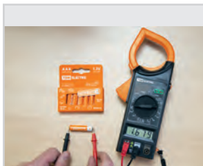
Измерение постоянного тока и напряжения.
