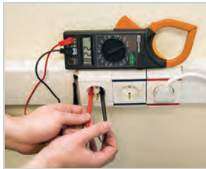
Измерение переменного тока и напряжения.
