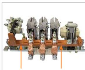
Траверса, на которой установлены подвижные силовые контакты, изготовлена из пресс-материала типа АГ-4В, устойчива к механическим (в том числе – ударным) нагрузкам и несколько легче, чем в серии КТ6000, что сказывается на снижении времени срабатывания контактора.
