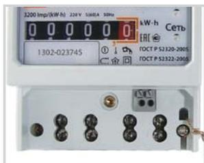
Каждый проводник крепится к клеммной колодке 2 винтами.
