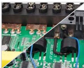
В качестве датчика тока в счетчиках прямого включения используется шунт, в счетчиках трансформаторного включения – трансформатор.
