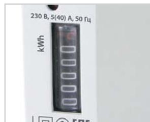
Для уменьшения размеров счетчика, отсчетное устройство развернуто на 90°.
