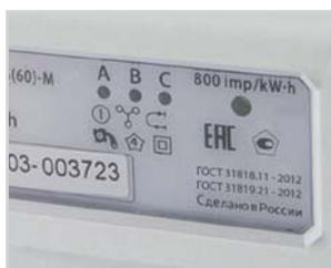
Счетчики в корпусе P7 имеют 1 LED-индикатор работы и 3 LED-индикатора наличия нагрузки в каждой фазе.
