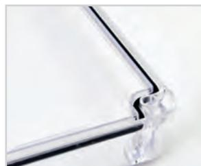
Уплотнитель по периметру крышки обеспечивает степень защиты IP55 от проникновения пыли и влаги. Без уплотнителя коробки имеют степень защиты IP44.
