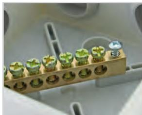
Шина 6x9 мм на 8 групп позволяет быстро и безопасно монтировать проводники сечением от 1,5 до 6 мм<sup>2</sup>.
