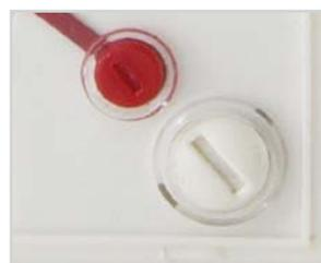
Имеется возможность корректировки нулевого положения стрелки прибора.
