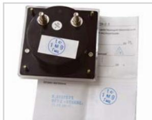
Приборы поверенной линейки имеют все соответствующие штампы на корпусе и в паспорте.
