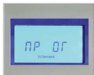
Электронный контроллер БАВРа позволяет точно задавать параметры верхнего и нижнего порогов напряжения. Позволяет предотвратить выход из строя дорогостоящих устройств в сети.
