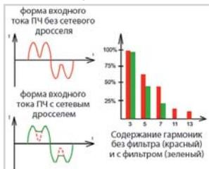
Если к одному источнику питания подключен ряд мощных электроприборов, входной реактор понижает скачок напряжения при включении и выключении.
