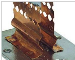
Плавкий элемент выполнен из фосфористой бронзы (сплав меди с цинком с добавлением фосфора) и надежно соединен точечной сваркой с выводами предохранителя.
