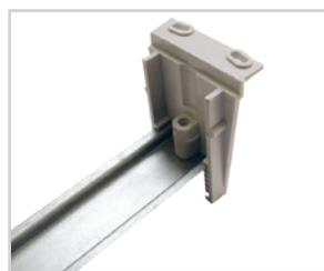
Для боксов навесного монтажа предусмотрен специальный кронштейн крепления DIN-рейки, который имеет 6 положений высоты и позволяет устанавливать оборудование с глубиной от 6 до 25 мм.
