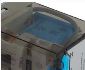
Номинальное напряжение катушки управления и тип тока (AC/DC) указаны на катушке реле под прозрачной крышкой.
