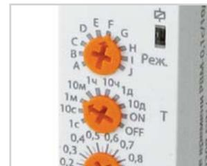
Возможность установки широкого диапазона значений времени от долей секунды до десяти дней, благодаря наличию двух переключателей: переключатель диапазонов (секунды, минуты, часы, дни) и переключатель установки десятичных долей от установленного значения (кроме РВД, РВО2, РВО4).
