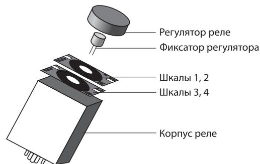
**Особенности эксплуатации и монтажа. Способы установки реле времени**
