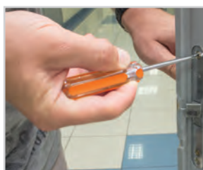
Удобство использования – рукоятки с углублениями и круговым рифлением в местах упора большого пальца.
