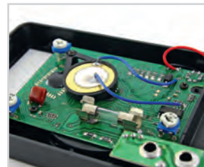
Мультиметры защищены от перегрузок по току с помощью предохранителя 500 мА/250 В.
