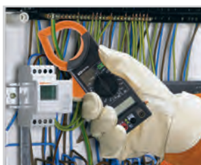
Конструкция клещей позволяет производить измерение переменного тока без прямого прикосновения к токоведущим частям.
