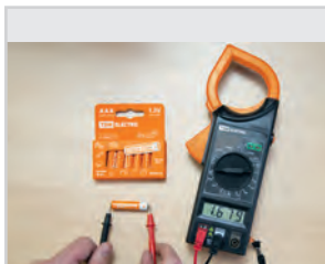
Измерение постоянного тока и напряжения.
