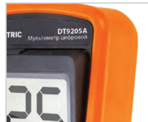
Мультиметры DT9205A, DT9208A, MAS830L имеют резиновый кожух, защищающий прибор от падений и ударов.
