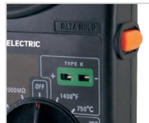
Все модели клещей и мультиметры DT9205A, DT9208A, MAS830L, M9300 оснащены кнопкой «DATA HOLD», которая записывает измеряемые показания.
